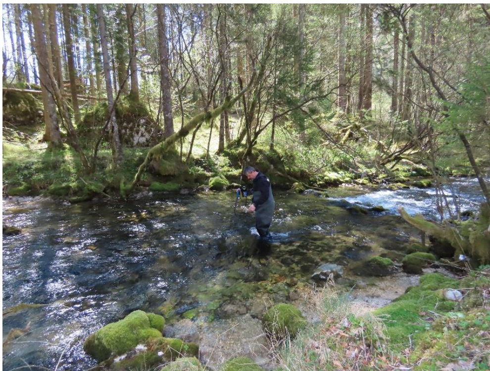
Slika 1. Meritev pretoka izvira Kamniške Bistrice v aprilu 2020 Figure 1. Discharge measurement of Kamniška Bistrica spring in April 2020
