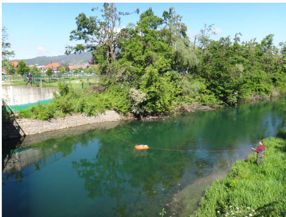
Slika 2. Meritev pretoka na območju izvira Ljubljanice (Močilnik) v Vrhniku 8. maja 2014 (Arhiv ARSO) Figure 2. Ljubljanica spring (Močilnik) discharge measurement in Vrhnika on 8th of May 2014 (ARSO archive)
