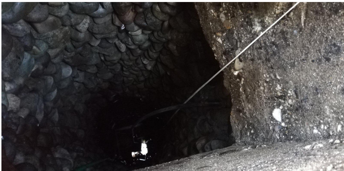
Slika 1. Meritev gladine podzemne vode v kopanem vodnjaku vodonosnika spodnje Savinjske doline, oktober 2020 (foto: P. Frantar)
