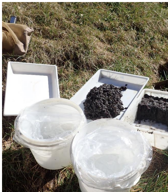
Slika 8. Prikaz deljenja in shranjevanja vzorca bentoških nevretenčarjev po izvedenem vzorčenju. Vir: ARSO Figure 8. Dividing and saving the sample after sampling of macroinvertebrates is done. Source: ARSO
