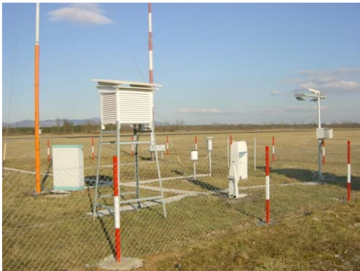
Slika 1. Meteorološka postaja na Letališču Cerklje, skrajno desno je senzor za sedanje vreme, levo od njega stoji merilnik višine baze oblakov
