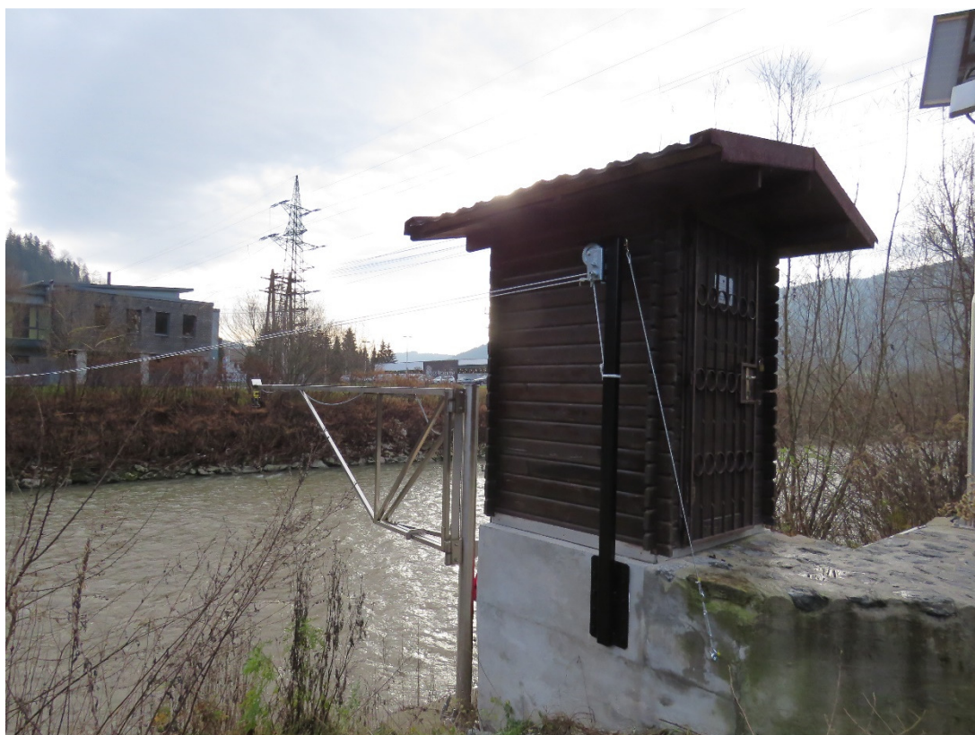
Slika 2: Začasna vrvna premostitev za izvajanje meritev pretoka visokih voda v Otiškem Vrhu na Meži (foto: Primož Gajser)
