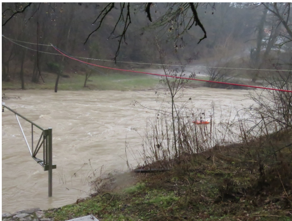
Slika 4: Meritev pretoka visoke vode Kokre v Kranju z ADCP merilnikom s pomočjo vrvne premostitve (foto: Marko Burger)
