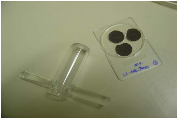
Slika 8: Prebijač za rezanje filtrov in razdeljen filter na tri enake dele, katere smo posredovali v različne laboratorije na analizo
